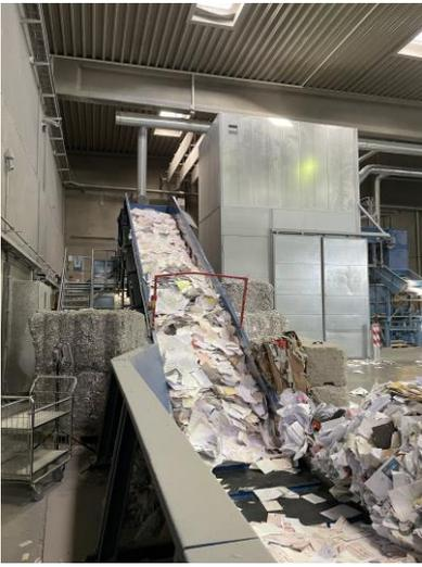
Fließband zur Shredder Anlage .
