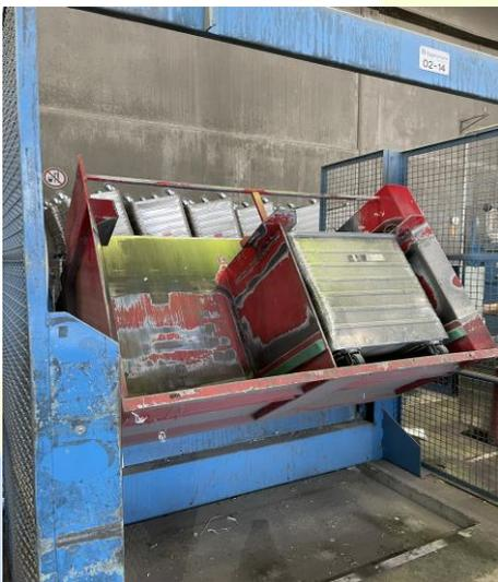
Mit Hilfe der Hub- Kippvorrichtung werden die Behältertypen DC 70, DC 240, DC 350 und DC 660 direkt auf das Fließband entleert.
